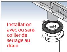
Installation avec ou sans collier de serrage au drain
